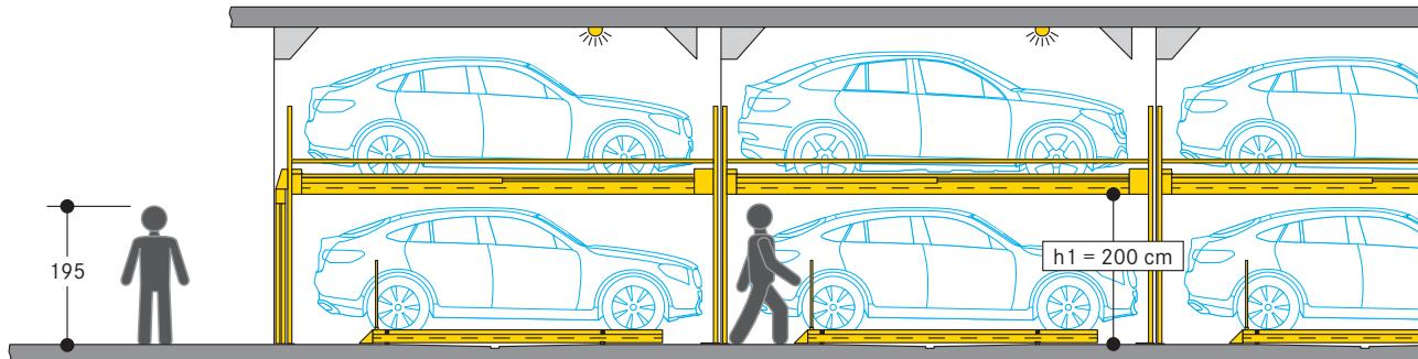
Bei einer Anlage, empfehlen wir eine lichte Höhe  $h_1$  von mindestens 180 cm.
