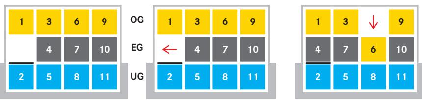
Über den Leerplatz kann bei MR-Anlagen in die hintere Anlage durchgefahren werden.
